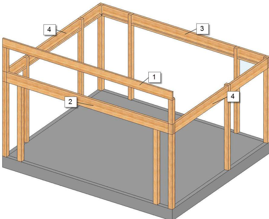
**3.** Lim og skru fast en 45x45 mm bjelke (10) i underkant på innsiden av den fremre bærebjelken samt på begge sidebjelkene. På den bakre bærebjelken monterer du en 45x70 mm bjelke (11). Lim medfølger ikke.
