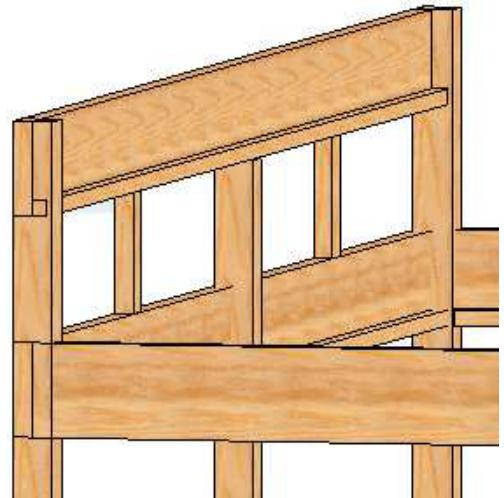
**4.** Monter gavlkilene (7) oppå sidebjelkene og mot de fremre stolpene. Disse festes i stolpene og sidebjelkene. OBS! Gavlkilen er ingen takbjelke, så på den skal det ikke monteres noen takprofil! Fortsett deretter med midttakbjelkene (5). Fordel disse i henhold til c/c-målet fra tegningen din. Utsparingene i midttakbjelkene plasseres i de monterte bjelkene på bærebjelkene.
