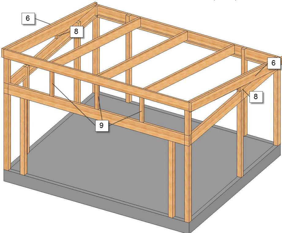
**8.** På de stedene hvor panelveggene skal monteres, skrur du nå fast vindkryssene. Kapp til bjelkene og skru dem fast i stolper og bjelker slik at de danner et kryss. Disse stabiliserer reisverket ytterligere, slik at hagestuen er nøyje justert før innfesting. Når vindkryssene er montert, kapper du til bjelkene til panelveggen og monterer dem mellom vindkryssene. Fortsett deretter med panelveggen i henhold til separat monteringsanvisning.
