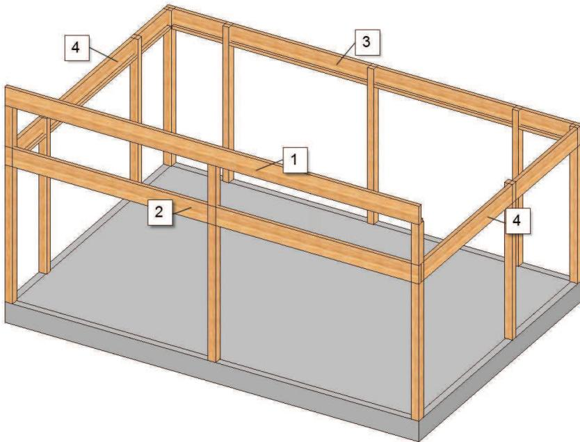
**3.** Limma och skruva fast regel(10) 45x45 mm i nederkant av insida främre bärlinna, samt på de båda sidobalkarna. På den bakre bärlinan monteras regel 45x70(11).
