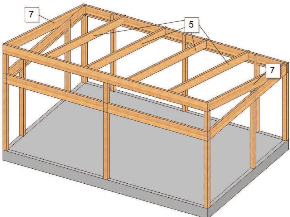
**5.** Skruva fast tassregeln(12) i ovankanten av den bakre bärlinan som en förlängning av mittakbalkarna. Denna skall både skruvas och limmas.
