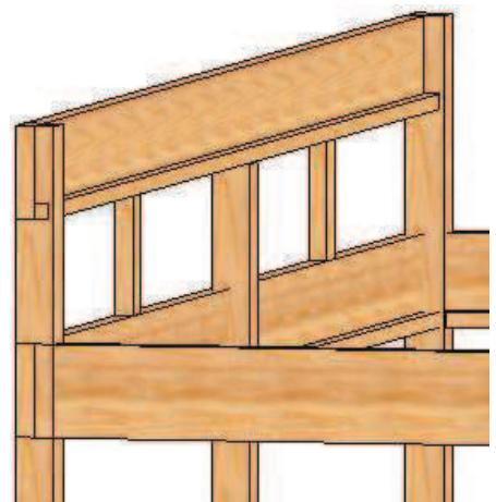
**4.** Montera fast gavelkilarna(7) ovanpå sidobalkarna och mot de främre stolparna. Dessa fästes i stolparna och i sidobalkarna. OBS! Gavelkilen är ingen takbalk och på denna ska ingen takprofil monteras!
