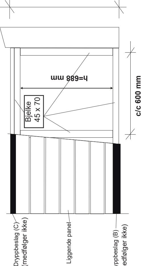
$h\text{ (mm)} = \text{tot. høyde (mm)} - 112\text{ (mm)}$
