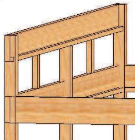
**4.** Monter gavlkilene (7) oppå sidebjelkene og mot de fremre stolpene. Disse festes i stolpene og sidebjelkene. OBS! Gavlkilen er ingen takbjelke, så på den skal det ikke monteres noen takprofil! Fortsett deretter med midttakbjelkene (5). Fordel disse i henhold til c/c-målet fra tegningen din. Utsparingene i midttakbjelkene plasseres i de monterte bjelkene på bærebjelkene.
