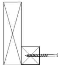
**4.** Monter gavkilene (7) oppå sidebjelkene og mot de fremre stolpene. Disse festes i stolpene og sidebjelkene. OBS! Gavkilen er ingen takbjelke, så på den skal det ikke monteres noen takprofil! Fortsett deretter med midttakbjelkene (5). Fordel disse i henhold til c/c-målet fra tegningen din. Utsparingene i midttakbjelkene plasseres på bærebjerkene.
