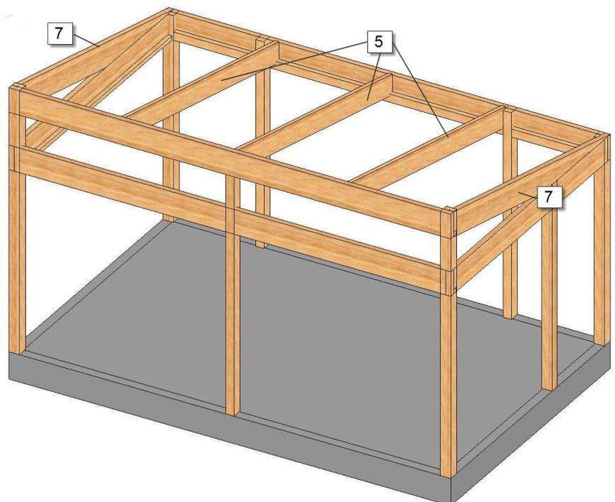
**5.** Skru fast kubbingen (12) mot overkant av den bakre bærebjelken som en forlengning av midttakbjelkene. Denne skal både skruses og limes.
