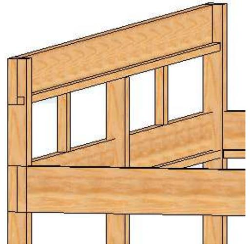
**3.** Lim og skru fast en 45x45 mm-bjelke (10) i underkant på innsiden av den fremre bærebjelken samt på begge sidebjelkene. På den bakre bærebjelken monterer du en 45x70 mm-bjelke (11).
