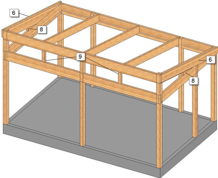
**6.** Monter deretter gavltakbjelkene (6). Disse skruses fast rett utenpå gavkilene. Følg overkanten av kubbingen og den fremre bærebjelken.
