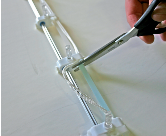
7. Leikkaa pois muovinauha, joka jää vaunun uuden pituuden ylimenevälle puolelle.
